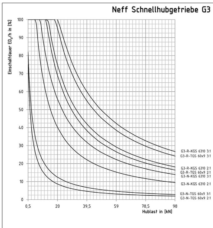
Um die Einschaltdauer  $ED_n/h$  für andere Drehzahlen zu ermitteln wird die Einschaltdauer in [%] mit dem Drehzahlfaktor  $fn_{neff}$  multipliziert:
