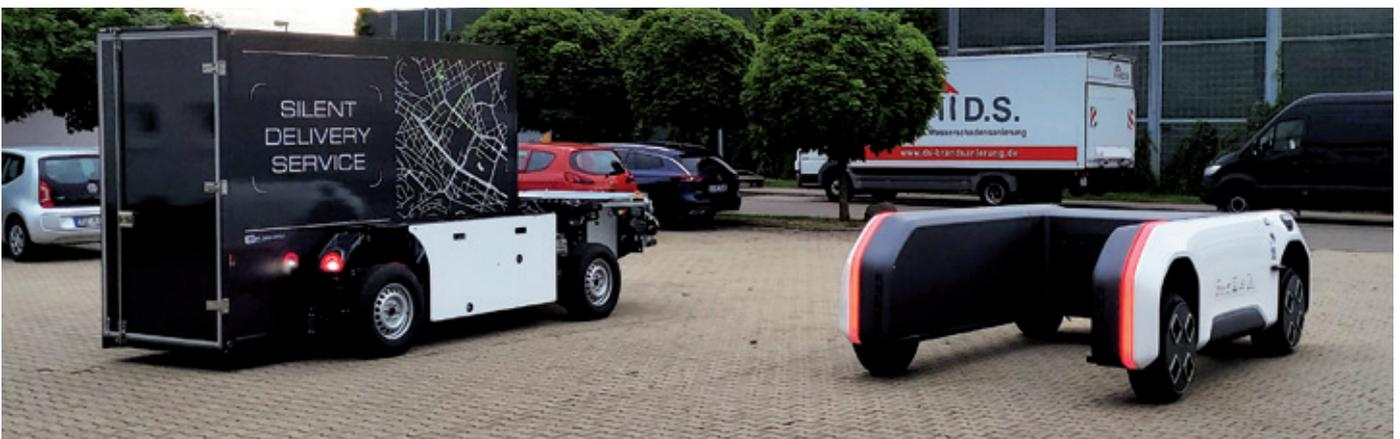
das Fahrzeug in eine Antriebs- und eine Nutzereinheit. Ein U-förmiges Fahrgestell beinhaltet alle technischen Komponenten und Systeme für autonomes, elektrisches Fahren. Die Nutzereinheit ist für eine Vielzahl an Einsatzmöglichkeiten im Personen- und Gütertransport ausgelegt.
